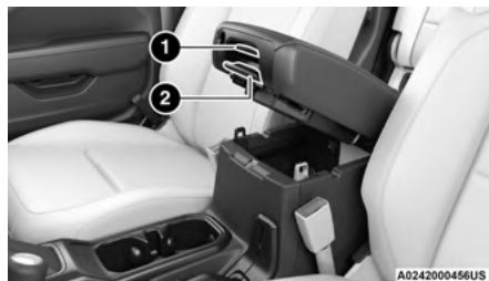
Pestillos del almacenamiento de la consola
