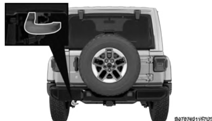
Gancho de remolque trasero
