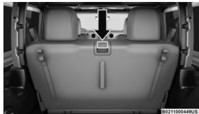
Palanca de liberación del respaldo del asiento trasero
