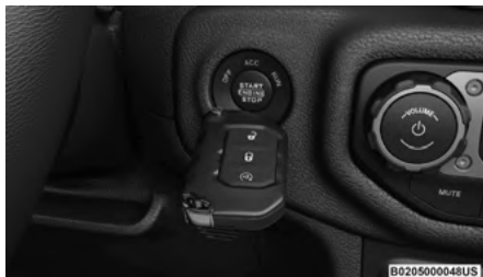
Método de arranque de respaldo
