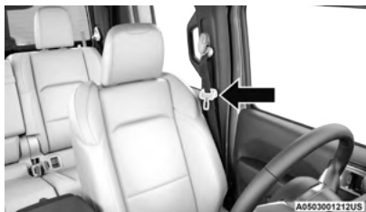
Extracción de la placa de cierre
