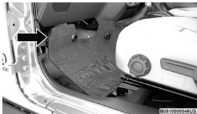
Alfombra delantera desmontada
