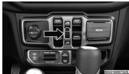
Interruptor de bloqueo de la ventana
