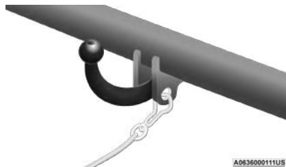
Método de lazo de enganche de bola fija
