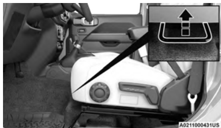
Ubicación de la barra de ajuste
