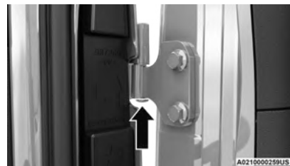
Tornillo del pasador de la bisagra
