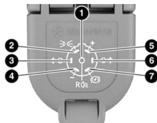
Conector de siete clavijas
