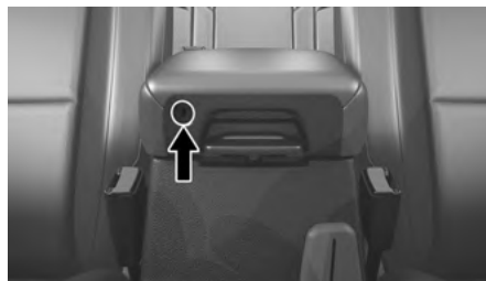
Bloqueo de almacenamiento de la consola
