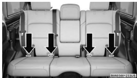
Anclajes ISOFIX (modelos de cuatro puertas)
