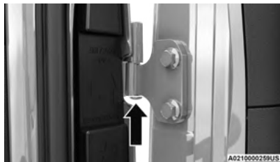
Tornillo del pasador de la bisagra
