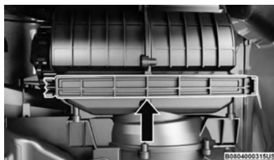
Filtro de aire de la cabina
