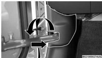
Puerta de acceso al cableado
