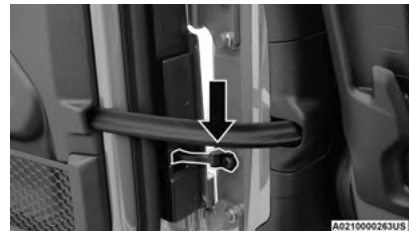
Retención de la puerta (conectada)
