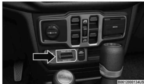
Tablero del interruptor de bloqueo del eje
