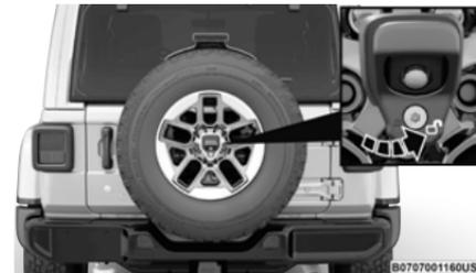
Desbloquear la cubierta de la cámara trasera
