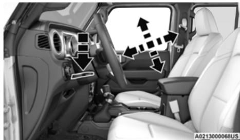
**Palanca de inclinación/telescópica
