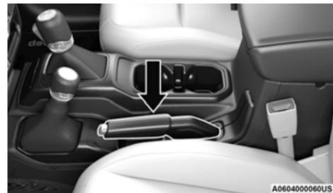
**Palanca del freno de estacionamiento**
