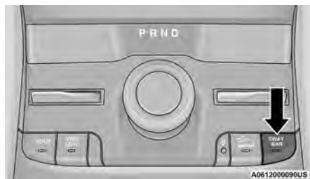
Interruptor de la BARRA ESTABILIZADORA
