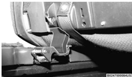
Retenedor colocado correctamente
