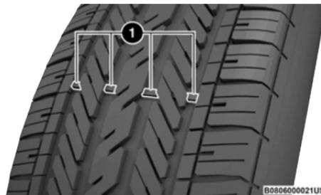
Banda de rodamiento del neumático
