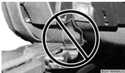
Retenedor colocado incorrectamente
