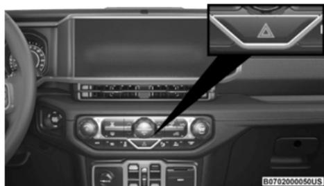
Presione el botón para encender las luces indicadoras de advertencia de emergencia. Cuando se activa este botón, todos los señalizadores de dirección destellan para advertir al tráfico acerca de una emergencia. Presione el botón nuevamente para apagar las luces indicadoras de advertencia de emergencia.
