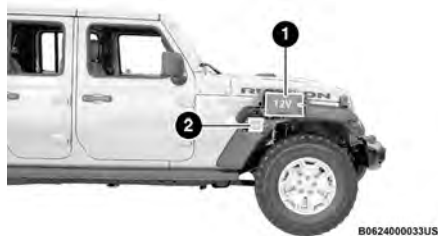
Ubicaciones de baterías
