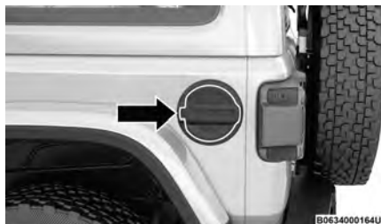
Compuerta de llenado de combustible
