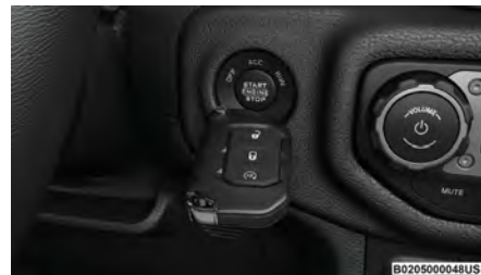
Método de arranque de respaldo
