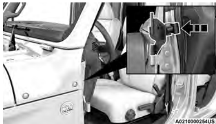
Empuje el soporte en el pilar A
