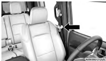
Extracción de la placa de cierre
