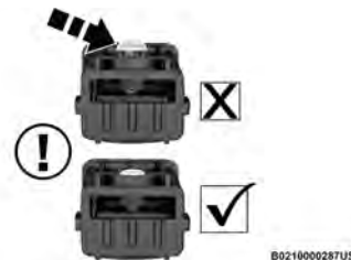
Cabeza de tornillo a ras del montante
