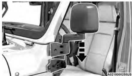
Baje el conjunto del retrovisor al soporte
