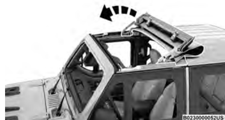
Presionar hacia delante la capota Sunrider®
