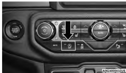
Interruptor OFF (Apagado) del sistema de Detención/Arranque
