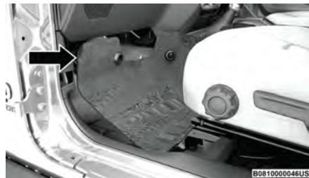
Alfombra delantera desmontada
