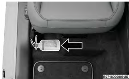
Ejemplo de ubicación del extintor de incendios
