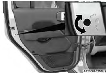
Función del sistema de seguros de las puertas a prueba de niños
