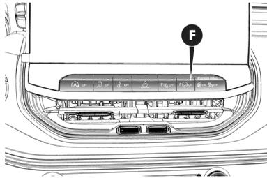
Las luces de LED también se encienden en caso de avería en el sistema Active ParkSense Active Park Assist. Pulsando el botón con el sistema averiado, el LED parpadea unos 5 segundos y luego permanece apagado.
