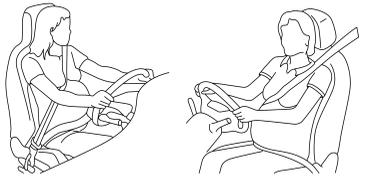
La correa del cinturón de seguridad no debe estar retorcida. La parte superior debe pasar por el hombro y atravesar diagonalmente el tronco. La parte inferior debe adherir a las ca-
