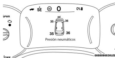
La presión de inflado varía con la temperatura unos 0,07 bar (1 psi) por cada 6,5°C (12°F). Esto significa que una disminución de la temperatura exterior comporta una disminución de la presión de los neumáticos. Ajustar siempre la presión de inflado de los neumáticos en frío. Esta última se define como la presión de los neumáticos después de un periodo de inactividad del vehículo de por lo
