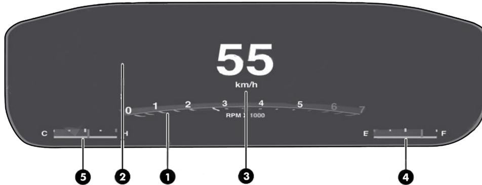
1. Tacómetro; 2. Pantalla multifunción; 3. Velocímetro; 4. Indicador del nivel de combustible; 5. Indicador digital de la temperatura del líquido de refrigeración del motor.
