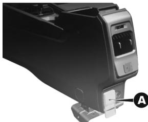
Para encender la toma del inversor de energía, conectar el dispositivo. La toma se apaga automáticamente cuando se desconecta el dispositivo.
