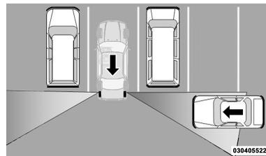
El sistema RCP controla las áreas de detección traseras en ambos lados
