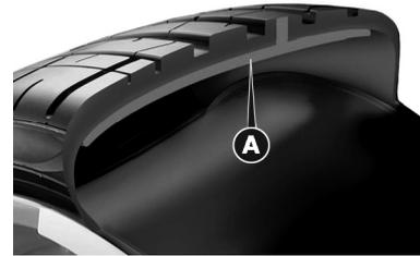
Esta tecnología permite que el conductor siga conduciendo y mantenga el control del vehículo, incluso con el neumático perforado, actuando inmediatamente sobre la perforación en una acción rápida y eficaz. En la mayoría de los casos, hace que el conductor no se dé cuenta de que el neumático se haya pinchado.
