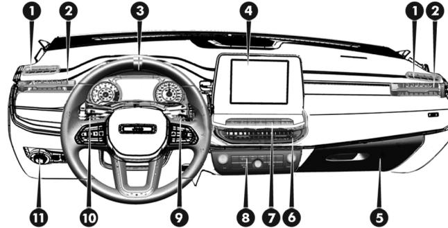
1- Difusores de aire fijos laterales 2- Difusores laterales orientables 3- Volante 4- Central Uconnect 5- Guantera 6- Difusores centrales orientables 7- Conjunto de controles del tablero 8- Controles de aire acondicionado 9- Palanca derecha (control de limpieza / lavado de los vidrios) 10- Palanca izquierda de control de luces de cruce / carretera y luces de giro) 11- Botones de control.
