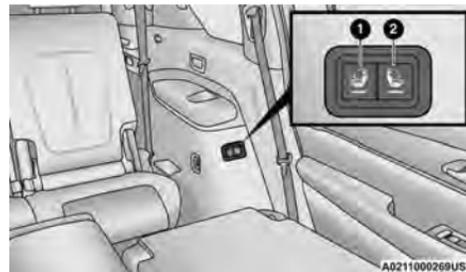
**Interruptores de pliegue eléctrico del pilar C (se muestra el lado izquierdo)**
