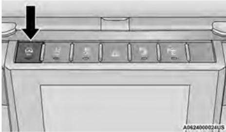
**Interruptor OFF (Apagado) del sistema de Detención/Arranque**
