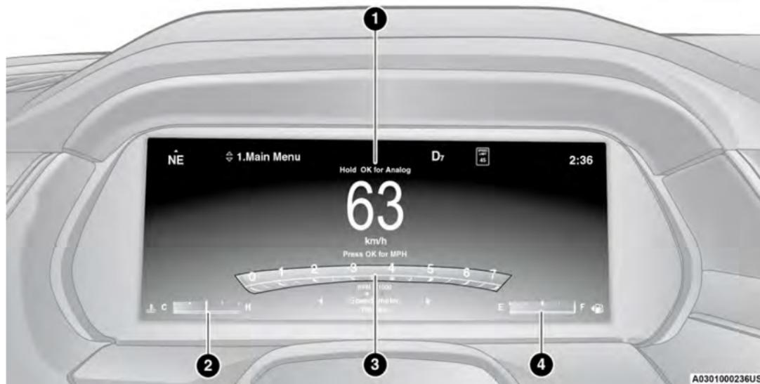
Mantener presionado el botón **OK** (Aceptar) en los controles de la pantalla del tablero de instrumentos ubicados en el volante le permiten cambiar la pantalla de digital a analógica.
