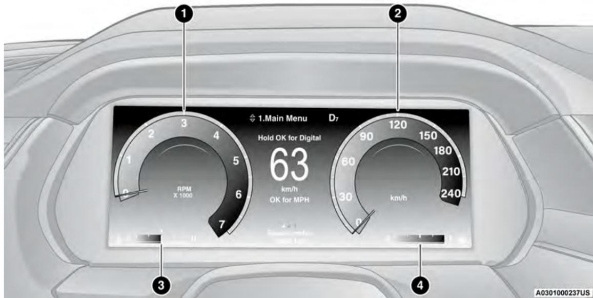
Mantener presionado el botón **OK** (Aceptar) en los controles de la pantalla del tablero de instrumentos ubicados en el volante le permiten cambiar la pantalla de analógica a digital.
