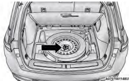
Fijación del neumático de repuesto
