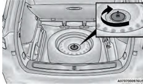
Volver a instalar la fijación del neumático
